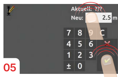
05 Geben Sie „2.5 m“ als Höhe ein (die Höhe zwischen Ihrem Löffel und der Grabensohle) und bestätigen Sie dann.
